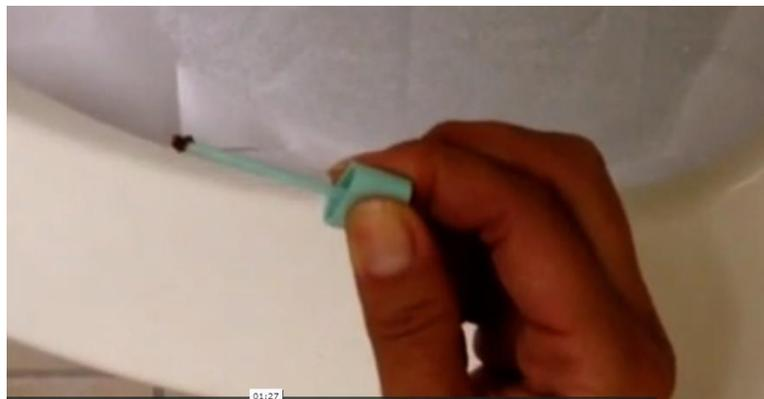
7. Inserte la sonda verde de muestreo en el frasco y ciérrelo firmemente. **NO LO ABRA NUEVAMENTE.**
